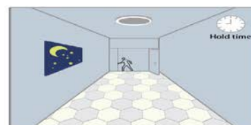
当延迟时间结束后, 感应器没有再检测到有人走动, 灯自动熄灭。
