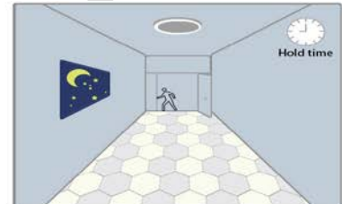
当延迟时间结束后，感应器没有再检测到有人走动，灯自动熄灭。
